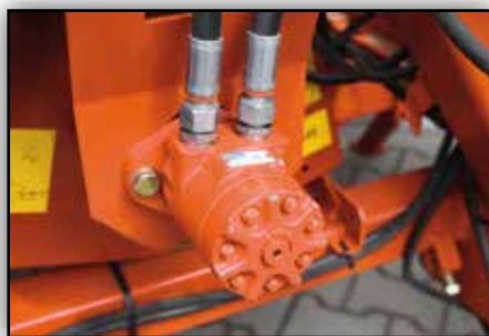
Optional external hydr. fan drive
